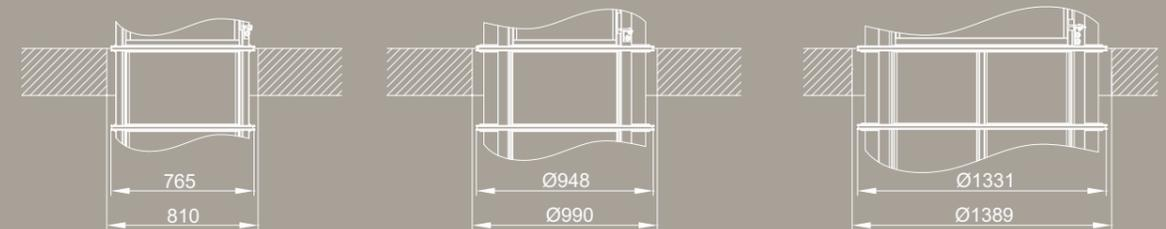
Minstdurchmesser für die Bohrungen, wenn der Aus- und Einstieg über das Gerüst erfolgen soll.
